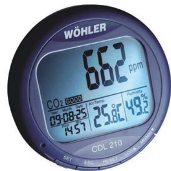
Bild 5.30: Kombi-Messgerät mit Datenlogger für die in Beurteilungsstufe 1, VDI 6022-3 genannten Parameter der Raumluftqualität: Feuchte, Temperatur, CO 2 . [Quelle: Fa. Wöhler]
